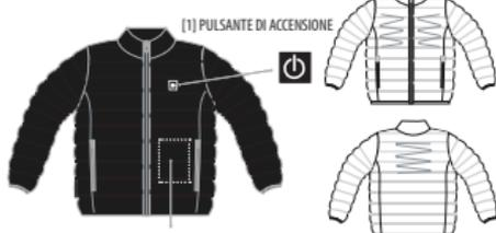
TASCA INTERNA PER L'INSERIMENTO DELLA BATTERIA. CAVO DI ALIMENTAZIONE DELLA BATTERIA NASCOSTO SOTTO QUESTA TASCA\*
